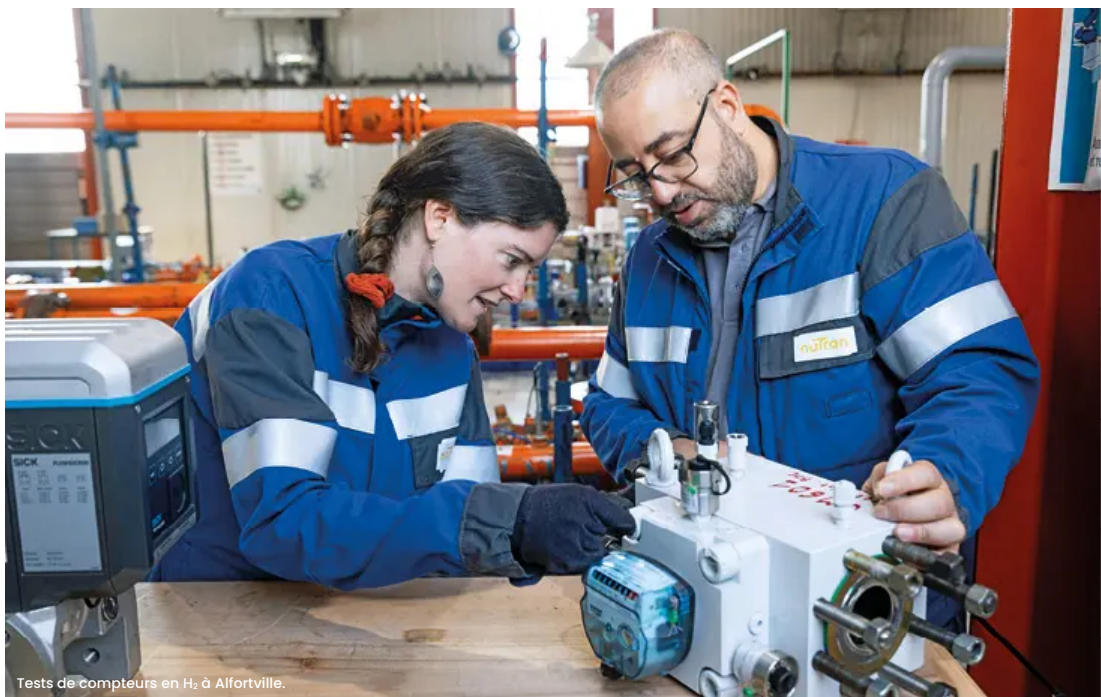
Tests de compteurs en H 2 à Alfortville.
