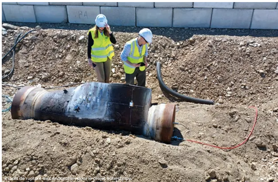
Essais de rupture de canalisation pour le projet GateH2pipe
