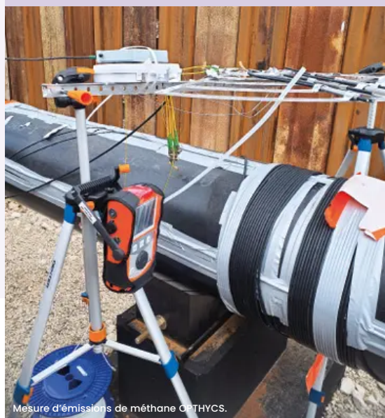
Mesure d'émissions de méthane OPTHYCS.
