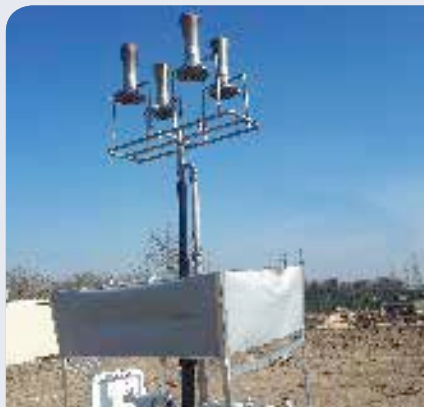
Une solution de brûlage alternative pour réduire les émissions de méthane avec une flamme invisible.
