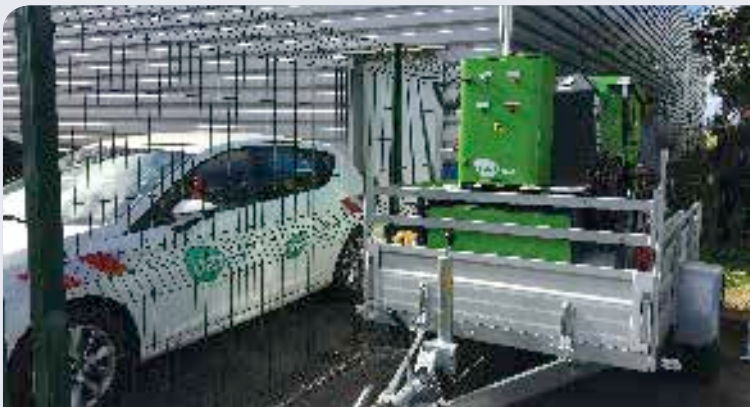
Une station GNV (gaz naturel véhicule) de compression et de stockage du gaz à la fois légère et mobile.
