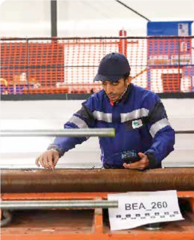
Caractérisation d'un défaut créé sur une canalisation de transport
